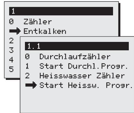
Start Entkalkungsprogramm heißwassersystem Abb. 20
